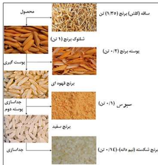
شکل ۱- تصویر محصولات مختلف به دست آمده در فرایند تولید برنج و نسبت محصولات فرعی آن
